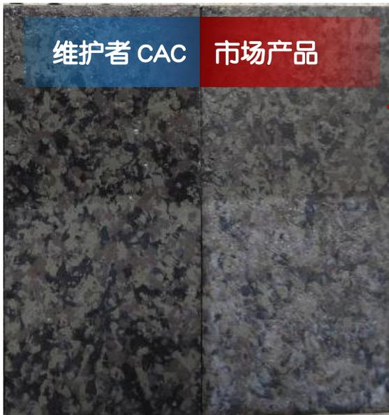
在无石棉纤维水泥板上喷涂 1 道多彩涂料，25℃，RH50%下养护 1d。
